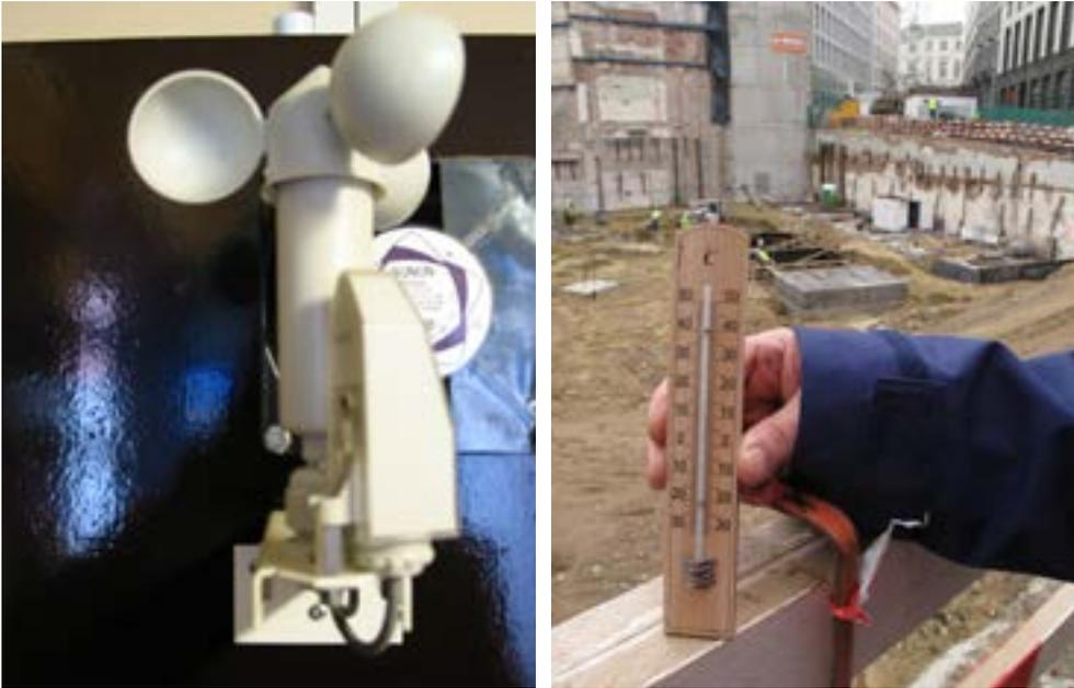
Il est très facile d'évaluer l'**exposition au froid** selon les critères légaux. Il suffit de mesurer la température avec le thermomètre classique tel que nous le connaissons tous (et avec lequel nous mesurons, dans le jargon, la « température sèche »). Si la température sèche descend sous 5°, des mesures doivent être prises et sont renseignées dans la partie sur la réglementation.
