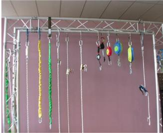
Il s'agit de la liaison entre le point d'ancrage ou le dispositif de retenue solidaire d'un ou de plusieurs points d'ancrage et le harnais (longe, antichute à rappel automatique, descendeur, antichute mobile à support d'assurage rigide ou flexible, connecteur, ...).solidaire d'un ou de plusieurs points d'ancrage et le harnais (longe, antichute à rappel automatique, descendeur, antichute mobile à support d'assurage rigide ou flexible, connecteur, ...).
